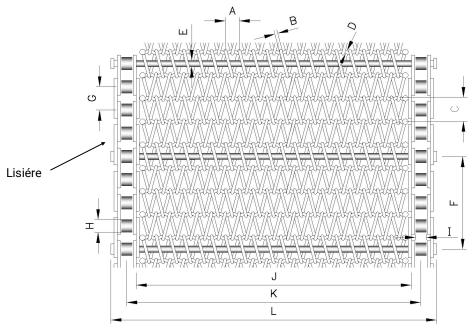
\*\* N.B.: Lors de la mesure des pas, A et C, il est préférable de mesurer 10 pas, puis de diviser le total par 10 pour obtenir le pas moyen.
